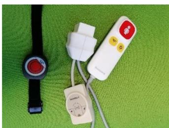
**Doubleur de lit** Ensemble permettant de remplacer temporairement le manipulateur d'appel du lit pour permettre d'avoir un dispositif supplémentaire d'appel pour un autre lit. Ce système se branche à la place d'une poire, d'un manipulateur existant.
